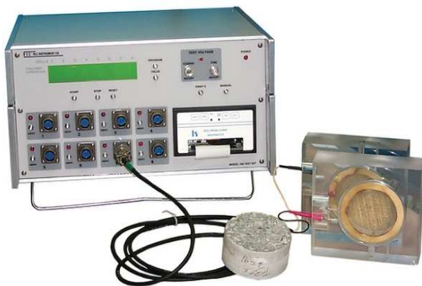
شکل ۲- دستگاه اندازه‌گیری قابلیت نفوذپذیری کلرید.
