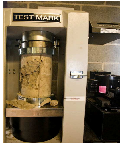
شکل ۵- دستگاه اندازه‌گیری مقاومت فشاری.
