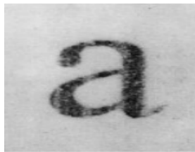
شکل ۲- تصویر چاپ شده با تونری که بار الکتریکی روی آن توزیع یکنواختی ندارد [۸].
