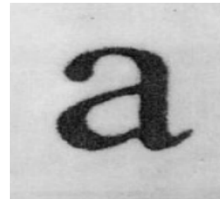
شکل ۳- تصویر چاپ شده با تونری که بار الکتریکی روی آن توزیع یکنواختی دارد [۸].
