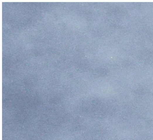
شکل ۱۴- تصویری از ابلقی شدن در یک روکش سطح خودروبی [۳۱].
