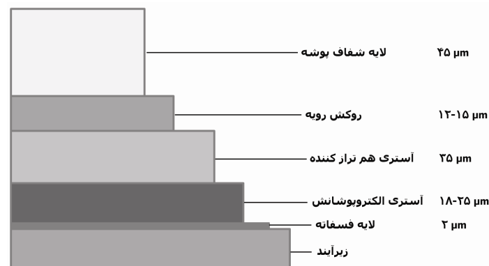
شکل ۱- نمایی از لایه‌های مختلف روکش سطح خودرویی امروزی [۳]
