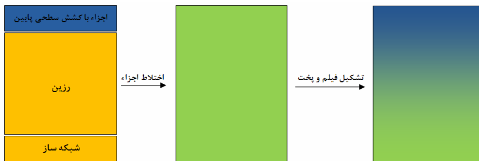
شکل ۱- نمایش تصویری فرآیند خود جداشوندگی اجزاء با انرژی سطحی پائین در یک مخلوط پوششی [۲۴]
