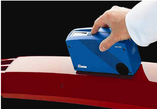
شکل ۱۰- دستگاه Wave scan برای اندازه‌گیری پوست پرتقالی روکش‌های سطح خودرویی [۵].
