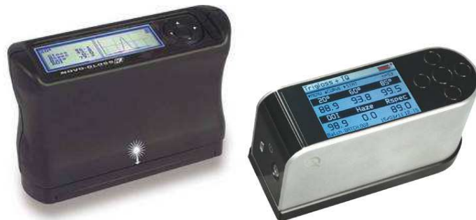
شکل ۹- تصویری از براقیت سنج (راست) و گونیوفتومتر (چپ) Rhopoint IQ ساخته شده توسط شرکت Rhopoint [۱۴، ۱۵]
