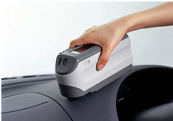
شکل ۲- تصویری از اسپکتروفوتومتر قابل حمل CM-2500C ساخته شده توسط شرکت Konica Minolta
