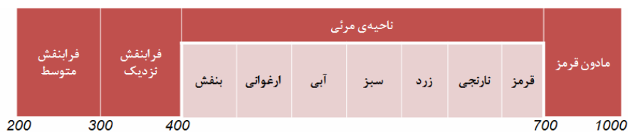
شکل ۲- جایگاه محدوده طول موج فرابنفش در میان امواج الکترومغناطیسی [۱۱].
