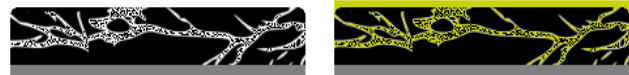
شکل ۲۹- نحوه نفوذ رزین اپوکسی حاوی مواد فلورسنتی به داخل حفرات و ترکها.
