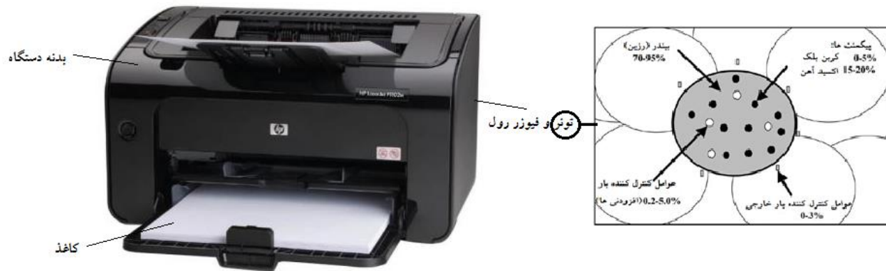
شکل ۳- قسمت‌های مختلف چاپگر (اجزای تونر) که آلاینده از آن نشر می‌شود [۱۹].
