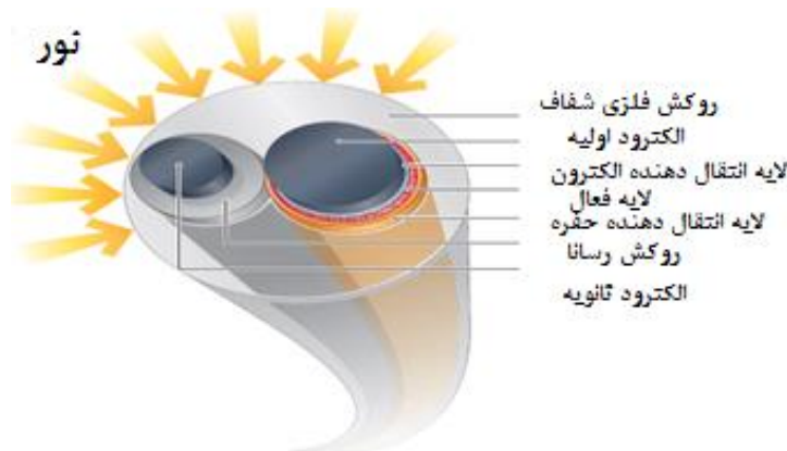
شکل ۱- شمایی یک سلول خورشیدی لیفی شکل که نور را از خارج سطح مقطع خود جذب می‌نماید [۷].
