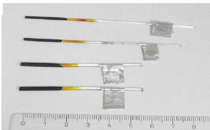
شکل ۶- تصاویر الیاف فتوولتائیک ساخته شده با قطرهای مختلف [۱۵].
