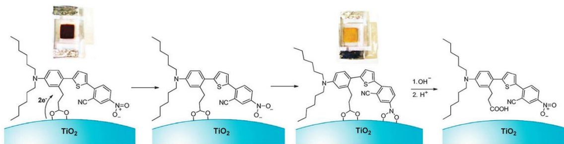
شکل ۵- تشکیل پیوند بین گروه نیترو و دی‌اکسید تیتانیم و تغییر فام ناشی از آن [۳۸].
