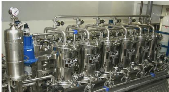
شکل ۱۸- سیستم میکروفیلتری شدن غشای الیاف توخالی پلی پروپیلن [۶۰].
