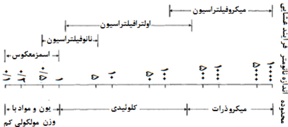
شکل ۱۷- محدوده کاربرد فرآیندهای اسمز معکوس، اولترافیلتری شدن، نانوفیلتری شدن و میکروفیلتری شدن برحسب اندازه حفره غشایی [۸].
