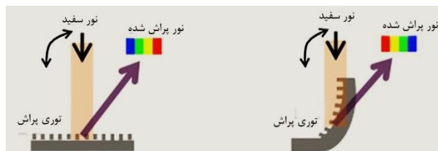
شکل ۹- چپ) تصویر شمایی از ساختار توری پراش معمولی و راست) تصویر شمایی از بال خمیده پروانه با حالت عمودی عناصر پراش در حالت انتقال نور [۳۷].
