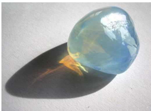
تصویر ۲- پراکندگی رایلی در شیشه شیری رنگ. نور پراکنده شده از زاویه جانبی آبی است ولی به رنگ نارنجی می‌درخشد [۲].
