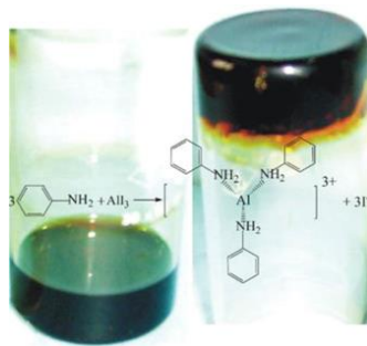
شکل ۴ - تشکیل الکترولیت ژل ANI - AlI 3 با برهم‌کنش بین اسید و باز لوییس [۱۰].
