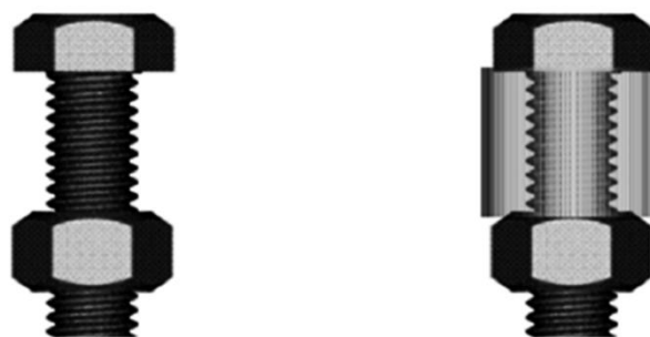
شکل ۷- نحوه قرارگیری پیچ و مهره در دستگاه گشتاورسنج [۳۸].
