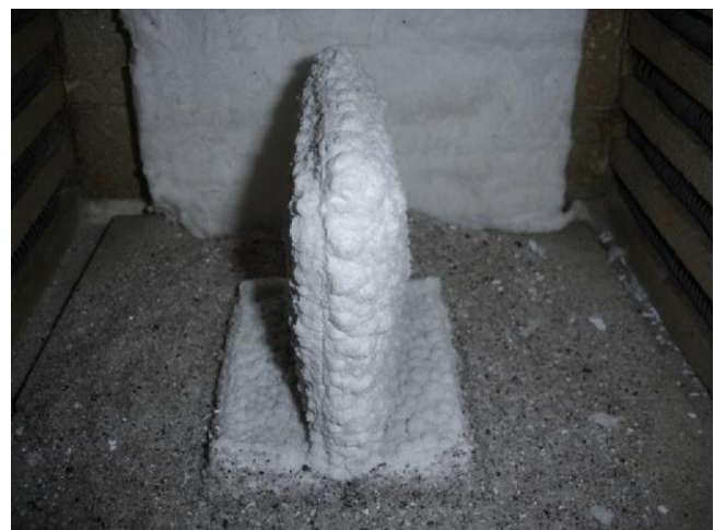
شکل ۱- نمونه رنگ متورم‌شونده روی اسکلت فلزی پس از آزمون حفاظت حرارتی [۱۶].
