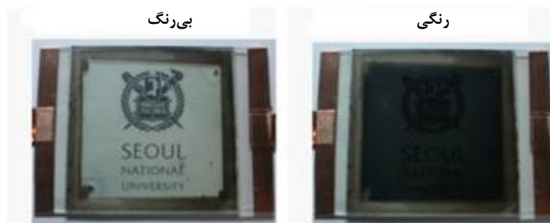
شکل ۱۵- عملکرد الکتروکرومیک NiO/Li^+/WO_3 : الف) تغییرات در عبور نوری: S2 (▲) و S1 (●)، ب) تلفیق عبور نوری در طول آزمون ۵۰۰۰ چرخه ای در قطعه الکتروکرومیک: حالت بی رنگ (■) و رنگی (●) و ج) تصاویر تغییر عبور را نشان می دهد، حالت بی رنگ (چپ) و حالت رنگی (راست) [۱۳].
