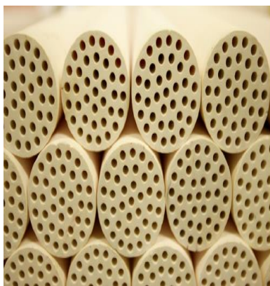
شکل ۴- یک دسته غشا آلومینا لوله‌ای بعد از مرحله پخت [۲۰].
