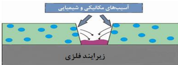
شکل ۴- شمای بازدارنده‌های بارگذاری‌شده در میکرو یا نانو حامل‌ها به عنوان یک پوشش خودترمیم‌شونده [۴۷].
