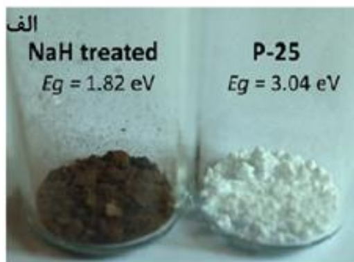
شکل ۱۲- الف) تصویر دی اکسید تیتانیوم و دی اکسید تیتانیوم احیا شده با \text{NaH} ب) طیف انعکاسی P-25 و دی اکسید تیتانیوم احیا شده توسط \text{NaH} نمونه‌های A 150^\circ\text{C} در محیط \text{N}_2 برای ۴ ساعت، B 120^\circ\text{C} در محیط \text{N}_2 برای ۴ ساعت همراه با لامپ UV، C 150^\circ\text{C} در محیط \text{N}_2 برای ۲ ساعت همراه با لامپ UV و D 150^\circ\text{C} در محیط \text{N}_2 برای ۴ ساعت همراه با لامپ UV [۱۸].
