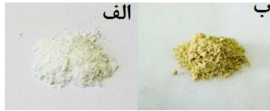
شکل ۳- تصویر آناتاز (الف) قبل و (ب) پس از فرآیند هیدروژن‌زایی تحت اتمسفر با جریان گازی 5\% H_2 / 95\% Ar به مدت ۷ ساعت [۹].
