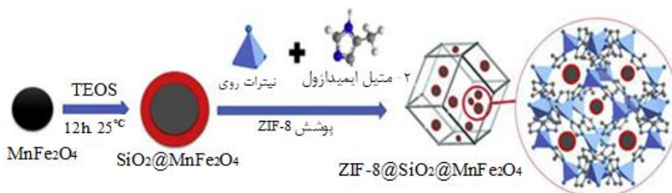
شکل ۱۱- طرح واژه نحوه تشکیل نانو کامپوزیت چارچوب آلی-فلزی مغناطیسی (MnFe 2 O 4 @SiO 2 @ZIF-8) [۸۳].
