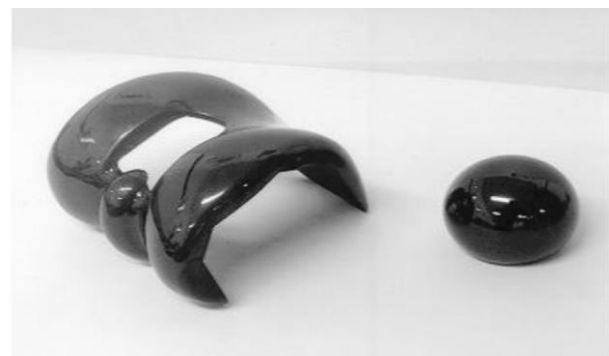
شکل ۱۰- تصویر کندیل زانو پوشش داده شده با DLC [۳۱].
