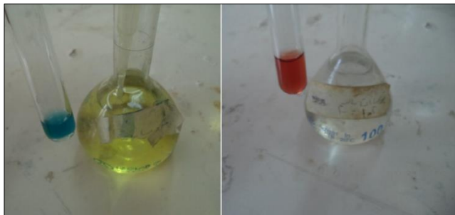
شکل ۴- آزمون شناسایی نوع رنگدانه سفال، تشکیل رسوب آبی پروس با افزودن معرف فروسیانید پتاسیم (سمت چپ) و تشکیل رسوب قرمز خونی با افزودن معرف تیوسیانات پتاسیم (سمت راست) (نگارنگان).
