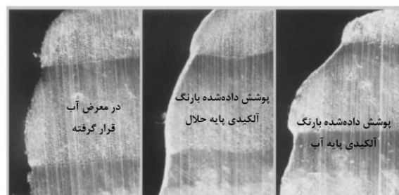
شکل ۱۰- واکنش چوب فشردگی شده به آب و رنگ‌ها [۳۸].
