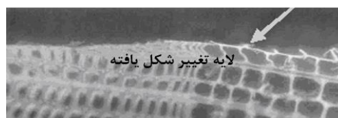
شکل ۹- چوب نوئل فشردگی شده به علت رنده‌کاری نامناسب [۳۸].
