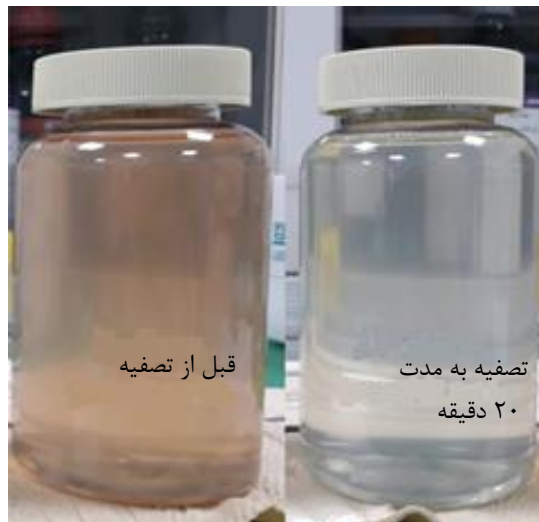
شکل ۶- پساب قبل و بعد از تصفیه پلاسمای DBD چند سوراخه [۲].
