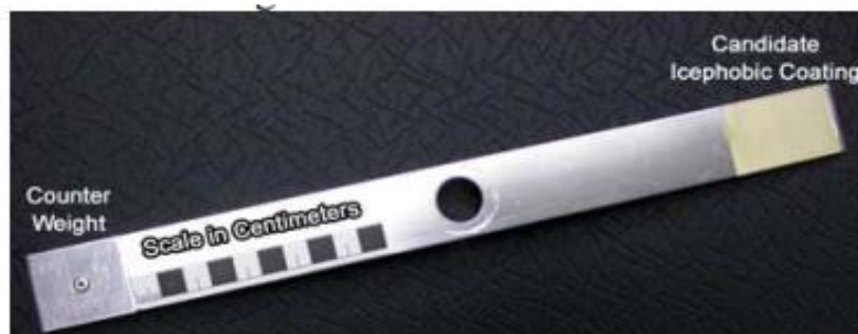
شکل ۳۴- تیغه آلومینیمی مورد استفاده در دستگاه سانتریفیوژ برای اندازه‌گیری چسبندگی یخ [۳۶].
