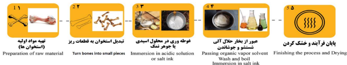
شکل ۴: فرآیند ساخت سریشم استخوانی به روش سنتی (نگارندگان). Figure 4: The process of making animal bone glue in the traditional way (authors).
