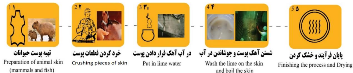
شکل ۳: فرآیند ساخت چسب سریشم پوستی به‌طور سنتی (نگارندگان). Figure 3: The process of making animal skin glue in the traditional way (authors).
