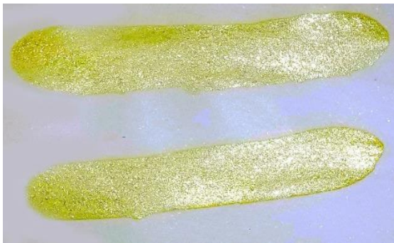
شکل ۲: جلا و درخشش لایقه نقره‌ای از ترکیب صمغ با طلق. این لایقه به صورت محلول بوده و پس از استفاده از آن بر روی سطح مورد نظر و مهره کشیدن آن تبدیل به لایقه محلول (حلی) شده و جلای فلزی مشابه طلا به خود می‌گیرد [۱].
