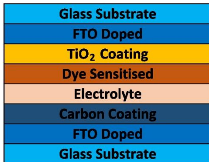
شکل ۱: ساختار لایه ای یک سلول خورشیدی حساس به مواد رنگزا [۱۰]. Figure 1: Overlapping Structure of a DSSC.
