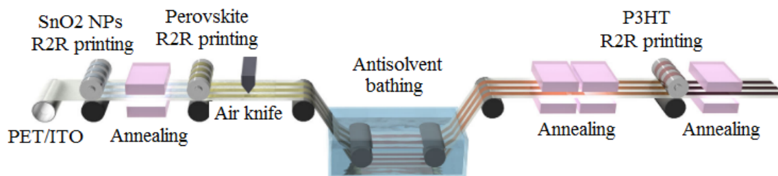
شکل ۱۱: طرحی از سیستم چاپ رول به رول (۹۲). Figure 11: A schematic of roll-to-roll printing system (92).
