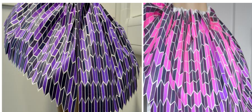
شکل ۱۲: لباس هوشمند تهیه شده توسط کالدر و همکارانش، چپ: حالت غیرفعال و راست: فعال شده (۷۳).
