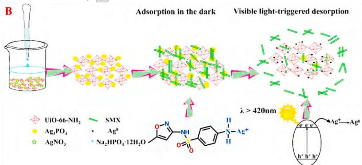
شکل ۳: نمودار طرح‌واره سنتز نانوکامپوزیت‌های MOF NP UiO-66-NH_2/Ag_3PO_4 و مکانیسم جذب و دفع آن‌ها برای حذف آلاینده‌های مواد رنگار و زیست محیطی (۴۲). Figure 3: The schematic diagram of the synthesis of UiO-66-NH_2/Ag_3PO_4 MOF NP composites and their adsorption-desorption mechanism. (42)
