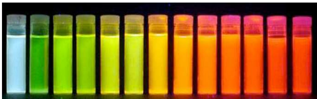
شکل ۲- تغییر رنگ نشر حاصل از تغییر اندازه ذرات نقاط کوانتومی CdSe. اندازه ذرات از سمت راست به چپ سیر نزولی دارد. رنگ آبی و قرمز به ترتیب مربوط به نقطه کوانتومی با اندازه ذره ۵ و ۲ نانومتر می‌باشد [۷].
