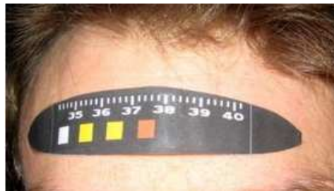
شکل ۱۶- نمونه‌ای از کاربرد بلورهای مایع ترموکروم در نمایشگر درجه تب.
