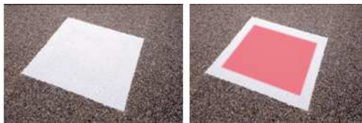
شکل ۴- اعمال رنگ ترموکروم حساس به دمای پایین در پوشش‌های ترافیکی به عنوان علائم هشدار دهنده یخ‌زدگی جاده.
