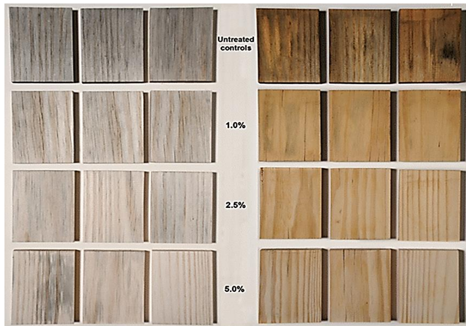
شکل ۷- نمونه‌های تیمار شده و نشده با نانواکسید روی پس از ۱۲ ماه هوازدگی. نمونه‌های تیمار نشده در سمت چپ تصویر می‌باشند [۴۳].
