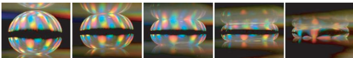
شکل ۴- شمایی از فشردگی قطره بین دو پس زمینه مشابه و انتقال حالت ترشوندگی آن [۵].
