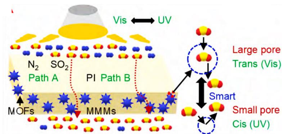
شکل ۲: چارچوب‌های آلی فلزی سلسله مراتبی پاسخگو به نور هوشمند، غشاهای بستر مخلوط را برای جداسازی گاز کارآمد ساخته‌اند (۴۶). Figure 2: Smart light-responsive hierarchical metal organic frameworks constructed mixed matrix membranes for efficient gas separation. (46).
