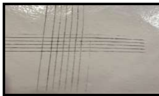
شکل ۱۴: آزمون چسبندگی در سطح آماده‌سازی شده با ساینده مسباره. Figure 13: Adhesion test (blasted copper slag surface).
