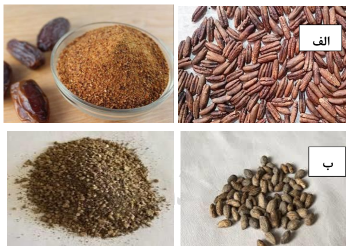
شکل ۱: جاذبهای مورد استفاده در پژوهش حاضر: الف) هسته خرما و پودر آن، ب) هسته زیتون و پودر آن Figure 1: Adsorbents used in the present study: a) Date kernel and its powder, b) Olive kernel and its powder
