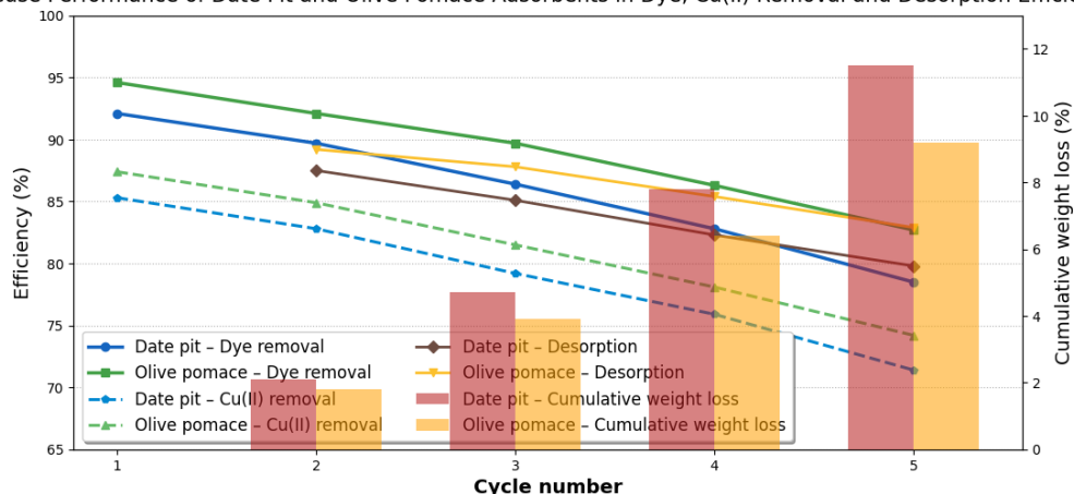
شکل ۲۱: مقایسه و ارزیابی عملکرد جاذب‌ها در چرخه‌های متوالی استفاده مجدد.
